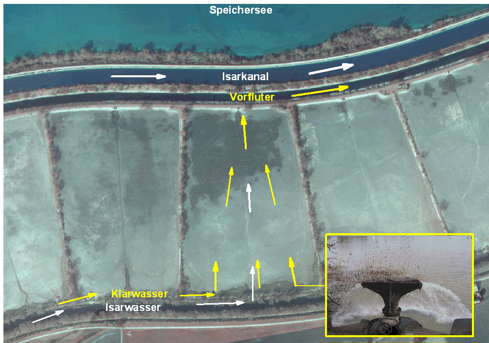
Abb. 1: Schema für das Wassermanagement in den 30 großen Teichen im Sommerhalbjahr
