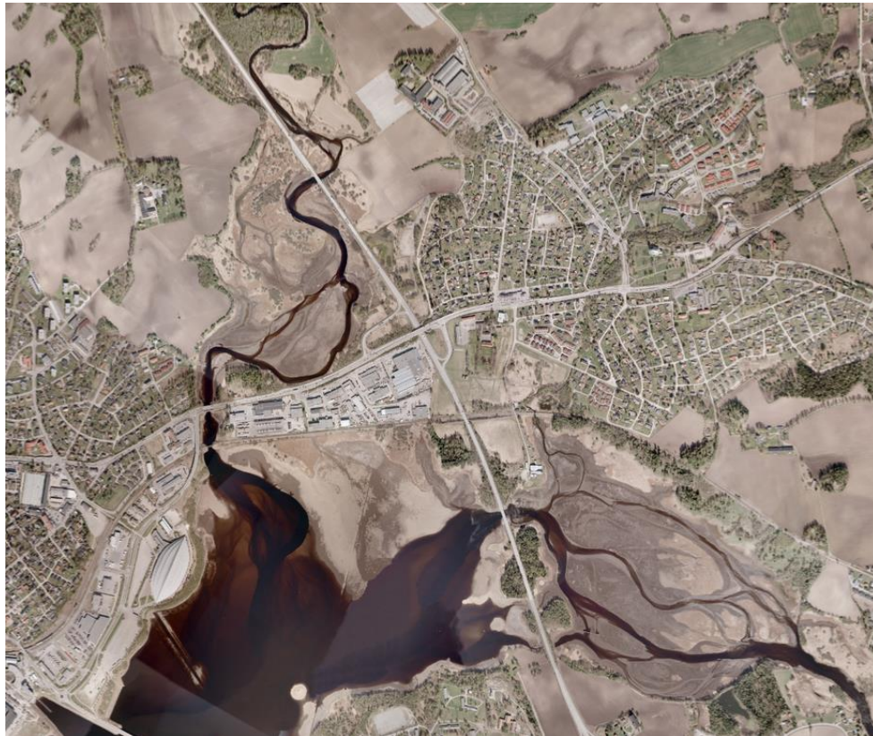
Bilde er fra 3. mai 2007 ved vannstand 121,05 meter i Mjøsa. Flagstadelva har en vannføring på 7,2 \text{ m}^3/\text{s} og Svartelva på 3,9 \text{ m}^3/\text{s}
