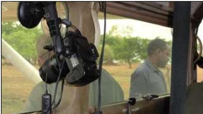
Chaque fois qu'un troupeau était trop important pour être dénombré à l'oeil nu (troupeau de 10 animaux ou plus) L'OAR avait la possibilité de prendre des photos grâce à un câble de déclenchement relié à un appareil photo fixé sur la fenêtre de l'avion et orienté vers la bande de comptage (Fig. 8)
