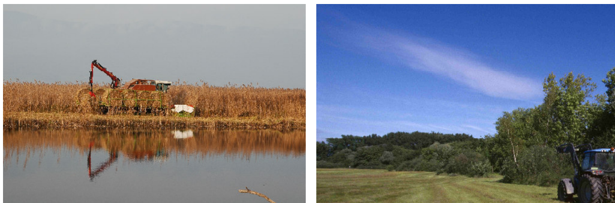
Figure 8.2.7b : Fauchage des marais. A gauche fauchage par la machine sur chenilles ELBOTEL. A droite fauchage par du matériel agricole traditionnel
