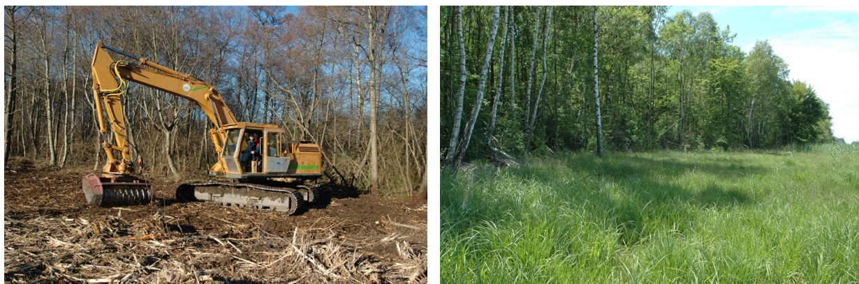
Figure 8.2.6c : Broyage et débroussaillage des marais embuissonnés A gauche : broyeur mécanique en action dans une clairière en cours de restauration A droite : lisière reculée par broyage et débroussaillage
