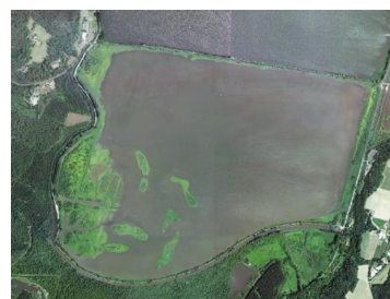
Marais Barrage à environ 2,00 m NGF (configuration écrêtage de crue lors de crise hydraulique)
