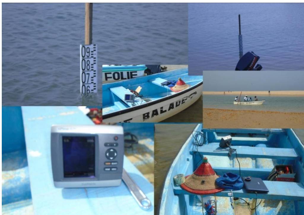
Figure 6 : Outils utilisés pour les levés bathymétriques
