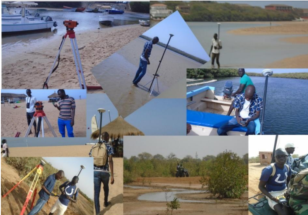
Figure 5 : Outils utilisés pour les levés topographiques
