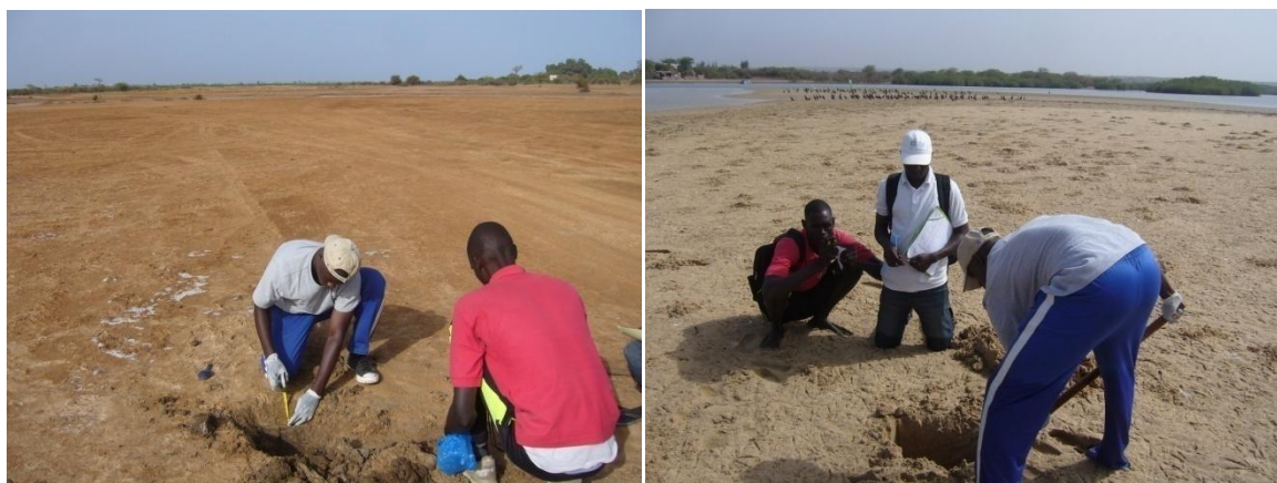
Photo 12 : Echantillonnage par carottage sur les bancs sableux et les tannes
