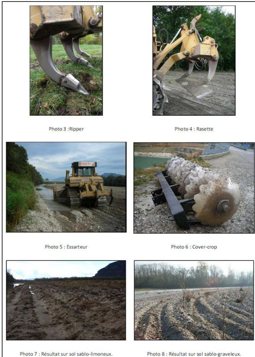
Figure 2. Engins d'entretien des bancs alluviaux et exemples de résultats (CNR, 11/02/2016)
