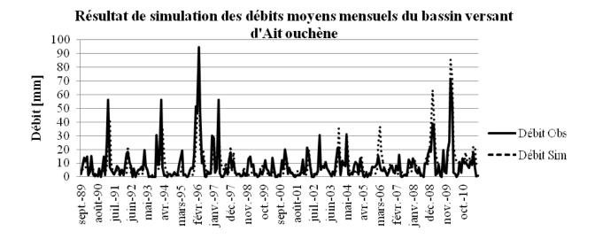
Figure 23: Simulation des débits moyens mensuels au niveau du bassin versant d'Ait Ouchène [1989 - 2010]
