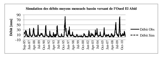
Figure 21: Simulation des débits moyens mensuels au niveau du barrage "bassin de l'Oued El Abid" [1985 - 2011]
