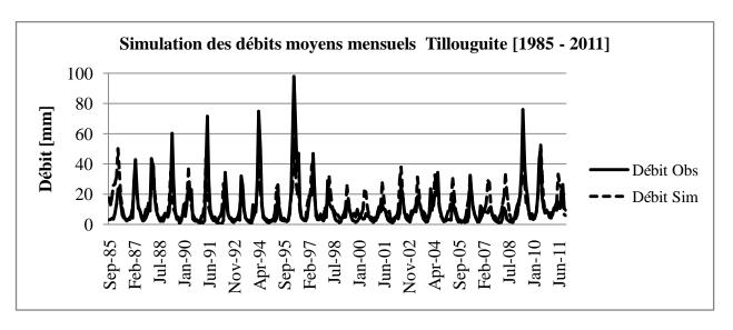
Figure 20: Simulation des débits à partir des pluies interpolées dans le sous bassin versant de Tillouguite [1985 - 2011]
