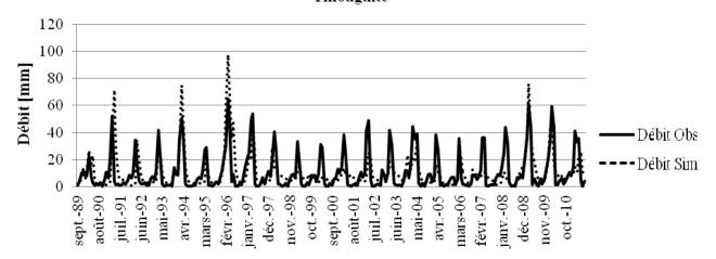
Figure 25: Simulation des débits moyens mensuels au niveau du bassin versant de Tillouguite
