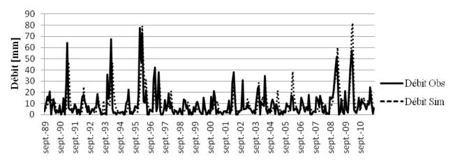
Figure 26: Simulation des débits moyens mensuels au niveau du BVOA
