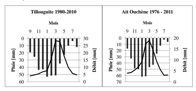
Figure 12: La relation pluie-débit au niveau des stations situées à l'exutoire des deux sous bassins versants
