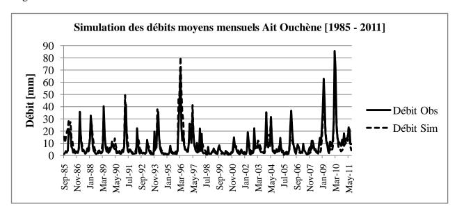
Figure 18: Résultat de simulation de débit au bassin versant d'Ait Ouchène avec la partie neige [1985-2011]
