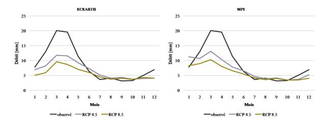
$Figure \ 31: Simulation \ des \ d\'ebits \ \grave{a} \ partir \ des \ pr\'ecipitations \ et \ ETP \ projet\'es \ sur \ la \ p\'erio de \ 2040 \ - \ 2060$
