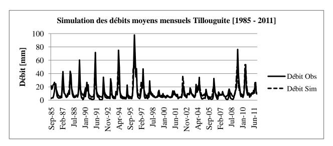
Figure 19: Simulation des débits à partir des pluies interpolées sur le bassin versant de Tillouguite [1985 - 2011]
