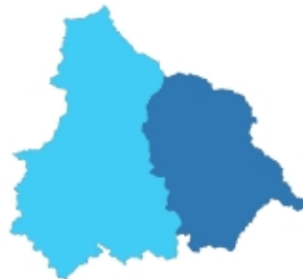
Cuencas Tempisque y Bebedero Autor(es): OET (2000) Cuencas de los ríos Tempisque y Bebedero, creadas a partir de análisis digital de la red hidrológica de las cuencas y utilizando un Modelo de Elevación Digital (MED), para la zona.
