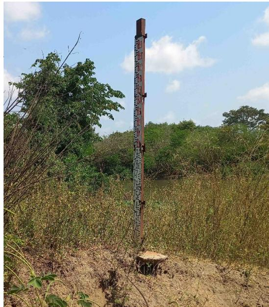
*Figure 28. Une échelle limnimétrique (7 à 9 m) est présente sur le site. Des données historiques sur les crues et les débits peuvent donc sans doute être récupérés et analysés. Une nouvelle instrumentation devra être mise en place pour le suivi (participatif).*
